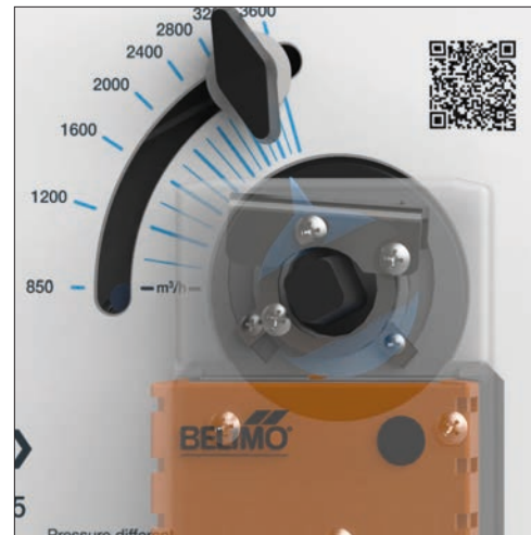
11. Die Handkurbel abschrauben, den schwarzen Druckknopf gedrückt halten und den Zeiger auf den gewünschten maximalen Luftstromwert einstellen. In diesem Fall wird er auf 2600 m³/h eingestellt. Den Druckknopf loslassen und die Handkurbel wieder festziehen.
