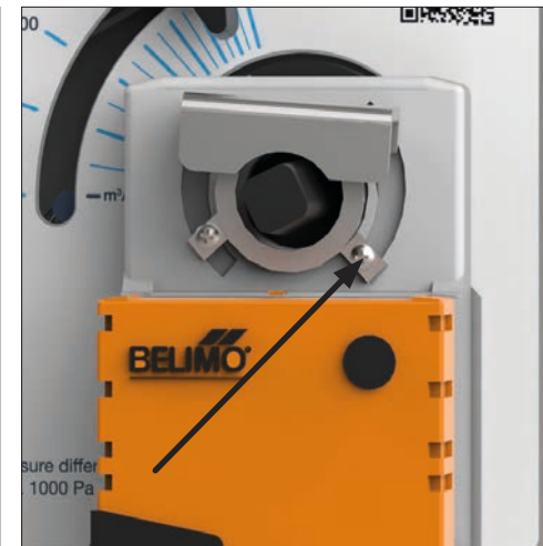
12. Die Schraube am rechten Anschlag abschrauben; unter die Backe schieben und festziehen.
