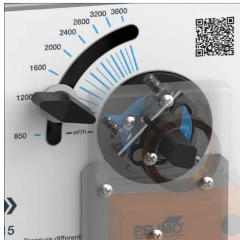
9. Die Handkurbel abschrauben, den schwarzen Knopf gedrückt halten und den Zeiger auf den gewünschten minimalen Luftstromwert einstellen. In diesem Fall wird er auf 1200 m³/h eingestellt. Den Druckknopf loslassen und die Handkurbel wieder festziehen.
