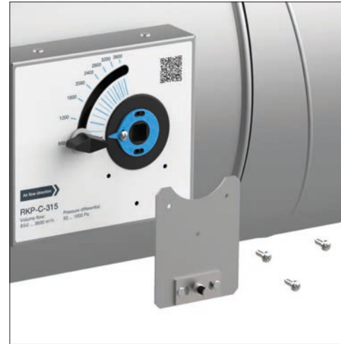
3. Den Produktaufkleber an den X-Markierungen durchstecken und die Motorhalterung mit drei 3,9x13 selbstschneidenden Schrauben DIN 7981 montieren.
