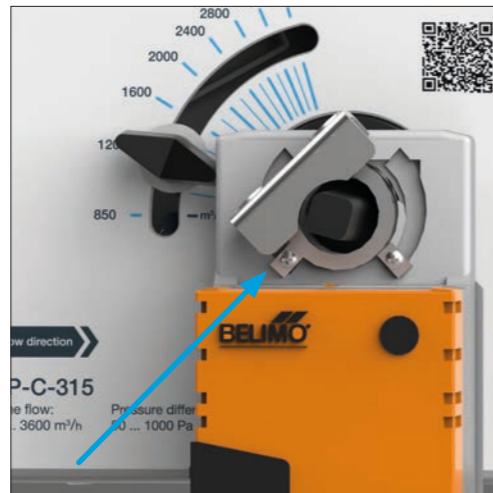
10. Die Schraube am linken Anschlag abschrauben; unter die Backe schieben und festziehen.
