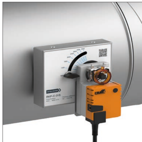
5. Den unteren Teil des Stellantriebs auf der Motorhalterung und den oberen Teil auf der Motorwelle verriegeln. Die seitliche Seite des Stellantriebs sollte parallel zur seitlichen Seite des Mechanismusdeckels sein.
